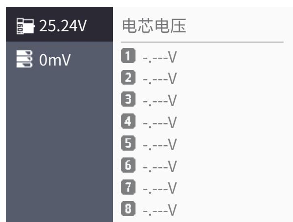
当XT60i接入普通电池时，将仅显示电池总电压值，需要查看各电芯电压必须接入平衡口。
