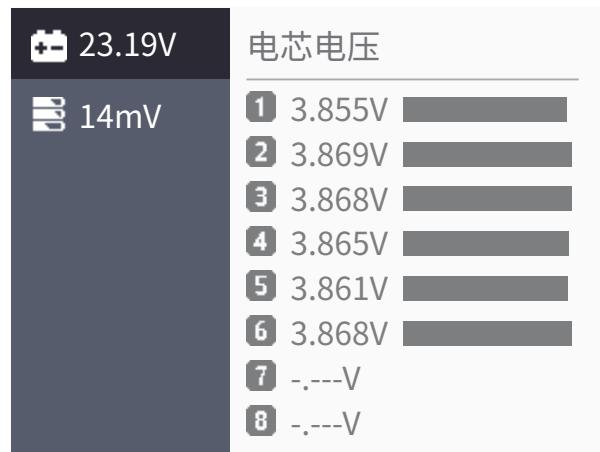
当平衡口接入电池时，将显示电池总电压值、电芯间最大压差及各电芯详细电压。
