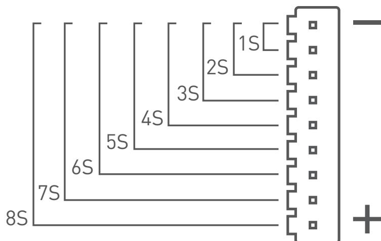
本产品检测口适用于连接 XH 2.54平衡接口的锂电池包, 连接电池时以“BAT-”作对齐, 上图演示平衡插头插入的对齐示意。当接入1S电池时, XT60输入必须大于5V电压才能工作。
