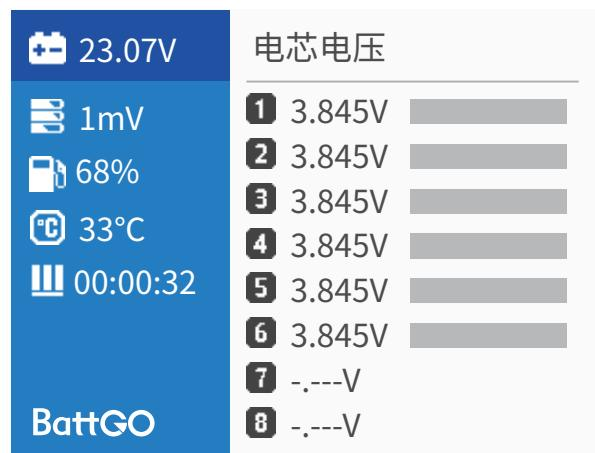
平衡完成时左边状态显示为蓝色，平衡完成后在熄屏状态呼吸灯变为蓝色
