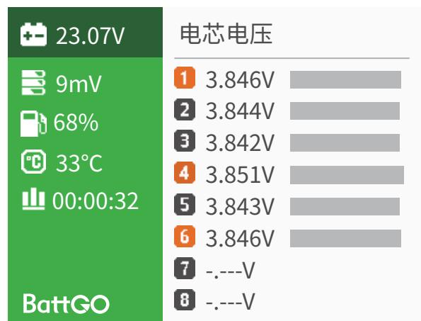
正在平衡的电芯标号显示为橙色，平衡进行中在熄屏状态呼吸灯变为绿色
