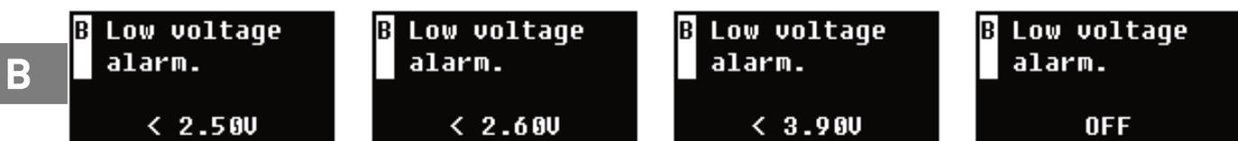
B 电池电芯低压报警阈值设置，可设定范围2.5~3.9V，OFF为关闭低压报警功能。
