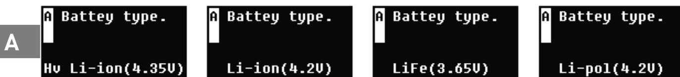
A 电池类型选择，此选择项将直接影响图形显示模式中的电量百分比显示。
