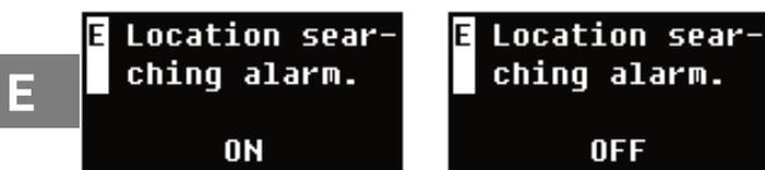
E 寻机报警功能设置，ON为启用，OFF为禁用；启用寻机报警功能后，电量计检测到电机已经运转过又停止超过一分钟后发出报警声。此功能为遥控模型坠机后寻找定位而设计，为确认此功能可靠生效请在地面进行功能测试，该功能启用后检测到电机开始启动或停止，电量计将发出相应提示声。地面测试电量计的电机运转检测功能正常后方可有效使用，由于模型电机，电调以及使用的电池差异较大，无法确保此设计适合所有模型，如电量计无法正常识别电机启停，请放弃使用该功能，或是使用F项设定代替寻机功能。
