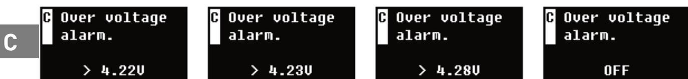
C 电池电芯超电压报警阈值设置，此设定与A项电池类型相关，可设定范围为满电压+20~80mV，OFF为关闭超压报警功能。
