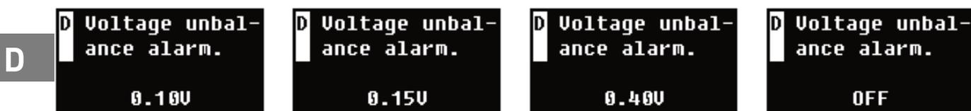
D 电池电芯平衡度报警阈值设置，当电芯间电压差异高于设定值时发出报警；可设定范围为100~400mV，OFF为关闭平衡度报警功能。
