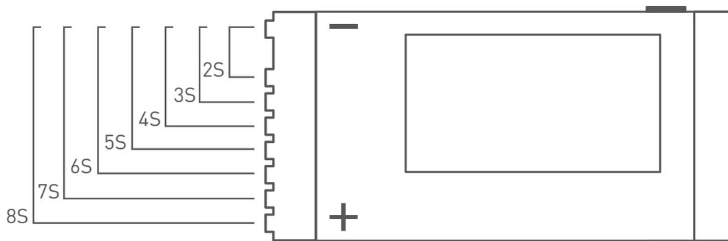
本产品检测口适用于连接JST XH 2.54平衡接口的锂电池包，连接电池时以“BAT-”作对齐，上图演示平衡插头插入的对齐示意。接入电池后，电量计即开始测量工作。
