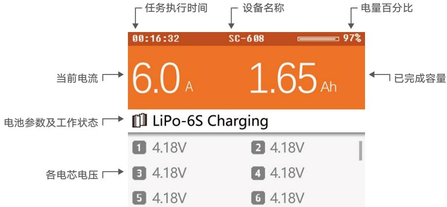
工作中旋转飞梭键可以切换屏幕下半部的信息显示内容，信息内容依次为：各电芯电压、各电芯内阻、工作参数。其中电芯电压及内阻仅在平衡充电模式下才会显示。
